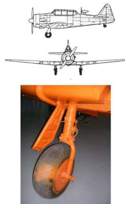
Figura 1: Velivolo e relativo carrello d'atterraggio.
